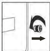
1. Afloje los cuatro tornillos con una llave inglesa
