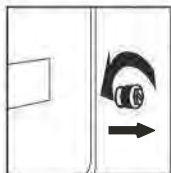
Desserrez les quatre vis à l'aide d'une clé.
