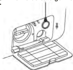
Varilla de emergencia
