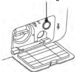
Varilla de emergencia
