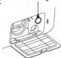
Varilla de emergencia
